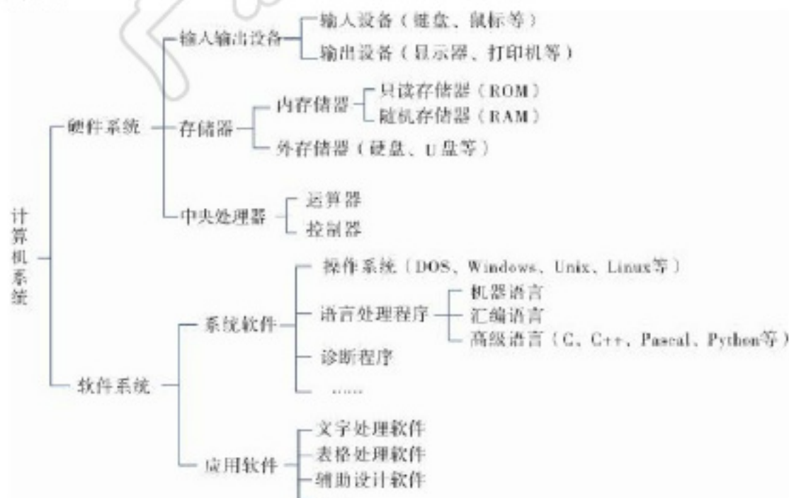
图2-12 计算机系统架构图
