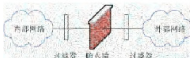
图5-7 防火墙系统示意图
