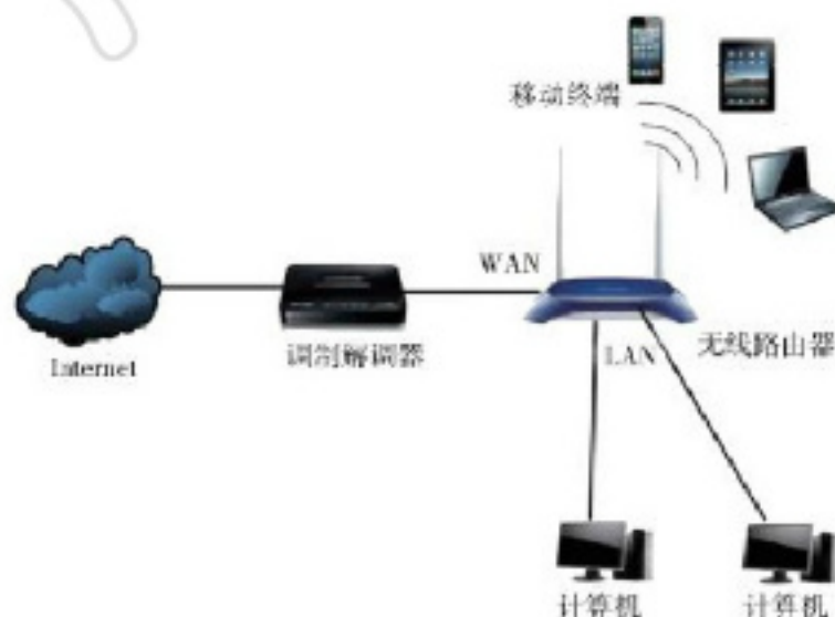
图3-16 小型无线网络示意图
